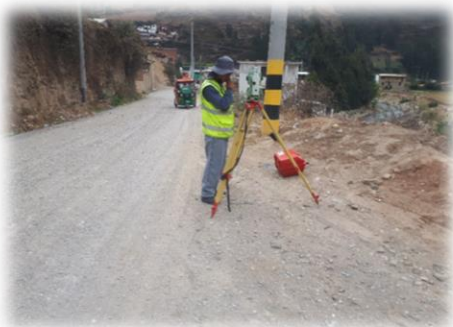
Levantamiento topográfico con estación total en el tramo Palca - Tarma.
